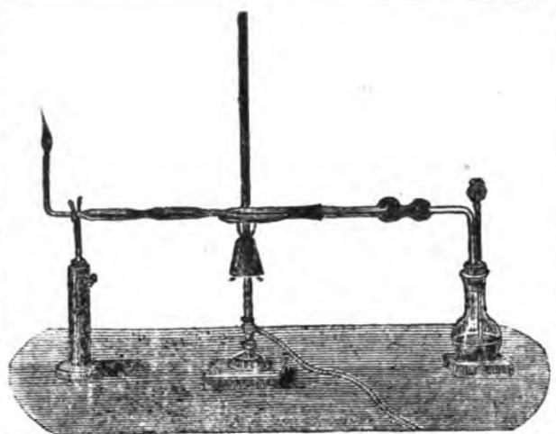
(丙) 取鋅和亞砒酸。置於燒瓶之中。瓶之栓塞開兩孔。一孔插漏斗管。一孔與滿盛氯化鈣之玻璃管連結。乃取稀硫酸自漏斗管口注入瓶中。則瓶中發生氣體。 $(\text{AsH}_3)$ 。由通過盛氯化鈣之玻璃而出。迨空氣驅盡。試點火於玻璃管端。則發蒼白色之燄而燃。以磁製之皿近之。則砒素附著於磁面。而生黑色之鏡。俗稱砒鏡。此砒鏡加以漂白粉溶液。則溶解。
