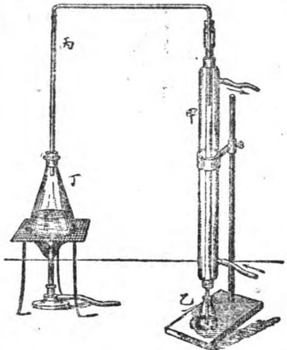
反應。以玻璃管丙聯絡之。使通於冷凝器甲。試於暗室內熱燒瓶至沸。則冷凝器中必見有綠色光帶。此即磷也。如磷之量甚多。則可集於乙瓶中。
